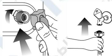
3. После подсоединения шлангов полностью откройте краны для проверки мест подсоединения на наличие протечек. В случае протечки закройте кран и отвинтите гайку. Проверьте прокладку и тщательно затяните гайку еще раз. Во избежание возможных протечек и связанного с этим ущерба закрывайте краны, когда машина не используется.
