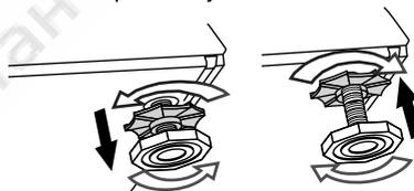
3. Затем вручную затяните все контргайки.
