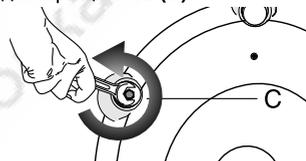
2. Осторожно поверните и выньте предохранительные транспортировочные болты.
