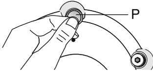
шланг (слева) (макс. 90 °С) подсоединяется к патрубку для горячей воды, а синий (справа) (макс. 25 °С) – к патрубку для холодной воды.
