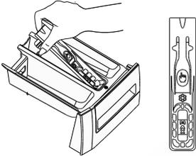
Поднимите заднюю часть сифона, чтобы его вынуть, как показано на рисунке.
